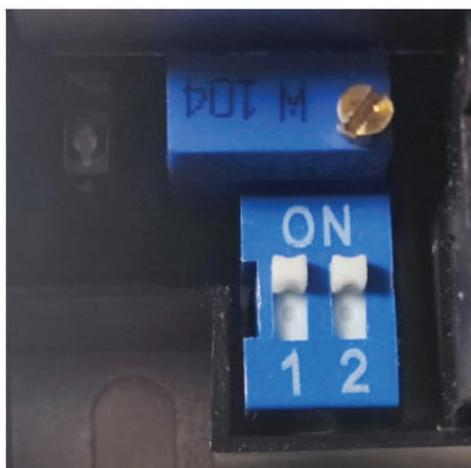
Lorsque les interrupteurs 1 et 2 sont tous deux en position « OFF » ou tous deux en position « ON », le mode de gradation ne fonctionne pas.
