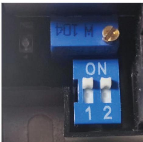
Cuando los selectores 1 y 2 están ambos en la posición "OFF" o ambos en la posición "ON", el modo de atenuación no funciona.
