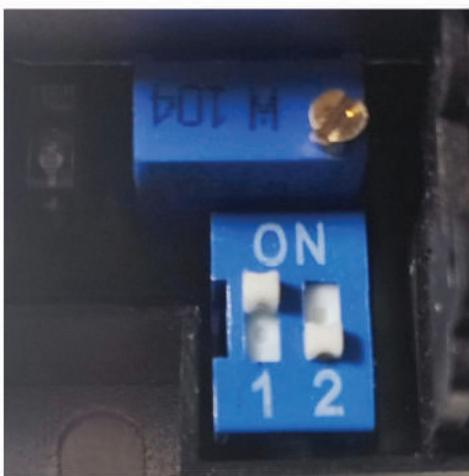
Lorsque le sélecteur 1 est en position « ON » et le sélecteur 2 est en position Position « OFF », le mode de gradation est entré.
