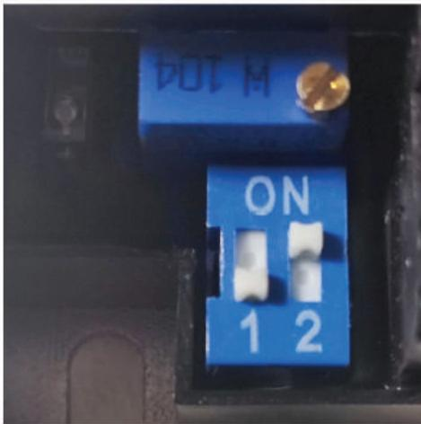
Quando l'interruttore 1 è in posizione “OFF” e l'interruttore 2 è in posizione “ON”, viene attivata la modalità di attenuazione graduale.
