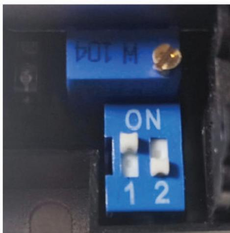
Cuando el selector 1 está en la posición “ON” y el selector 2 está en la posición “OFF”, se entra en el modo de atenuación.
