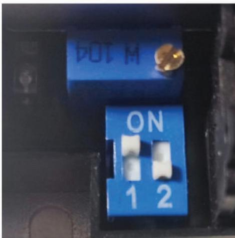
Quando il selettore 1 è in posizione “ON” e il selettore 2 è in posizione Posizione “OFF”, si accede alla modalità dimmerazione.
