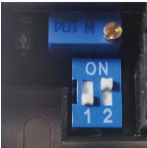
Lorsque l'interrupteur 1 est en position « OFF » et l'interrupteur 2 est en position « ON », le mode de gradation douce est activé.
