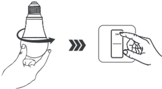
Setzen Sie die Glühlampe ein (im Uhrzeigersinn anziehen) und schalten Sie den Netzschalter ein.
