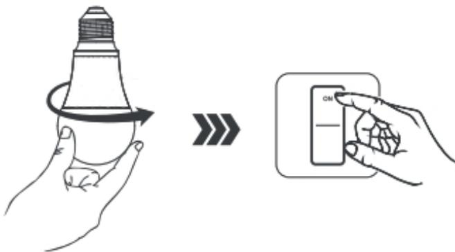
Instale a lâmpada (aperte-a no sentido dos ponteiros do relógio) e ligue o interruptor de alimentação.
