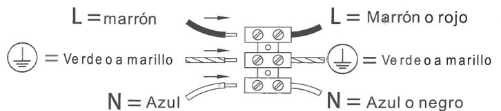
5. Conecte el cable al cable de luz.
