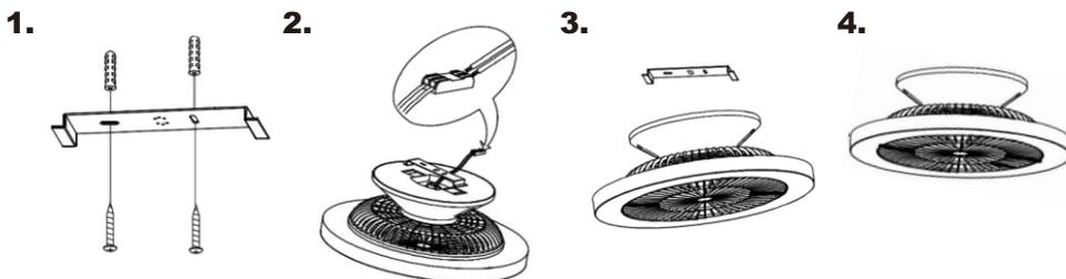
Antes de iniciar a instalação, certifique-se de desligar a energia e verificar a capacidade de carga do telhado. Remova o suporte do ventilador e fixe-o firmemente no teto (ver Figura 1).
